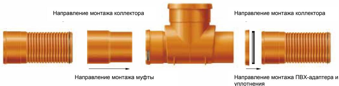
Схема присоединения кинет для труб из ПВХ с трубами "Pragma®"
