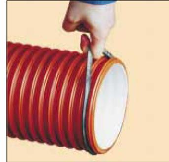
Уплотнение следует устанавливать так, чтобы при входе неоснащенного конца в раструб, кольцо сжималось в сторону из раструба. Такой монтаж позволяет полностью заполнить канавку, в которой находится кольцо и гарантирует полное эластичное прилегание к раструбу по всему периметру.
